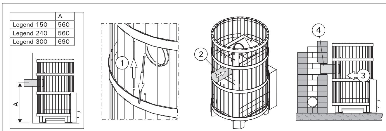
**Kuva 11. Kiukaan liittäminen muurattuun savuhormiin takaliitintäaukon kautta (mitat millimetreinä)**
