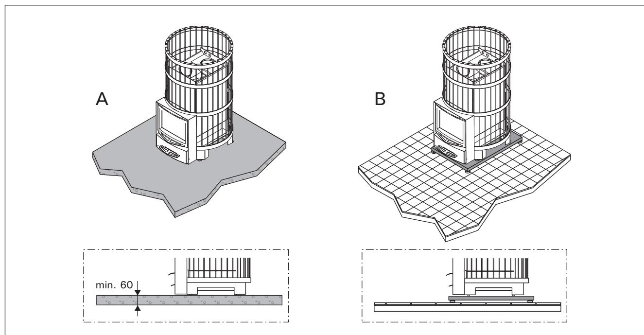
Рисунок 8. Защита пола (все размеры приведены в миллиметрах)
