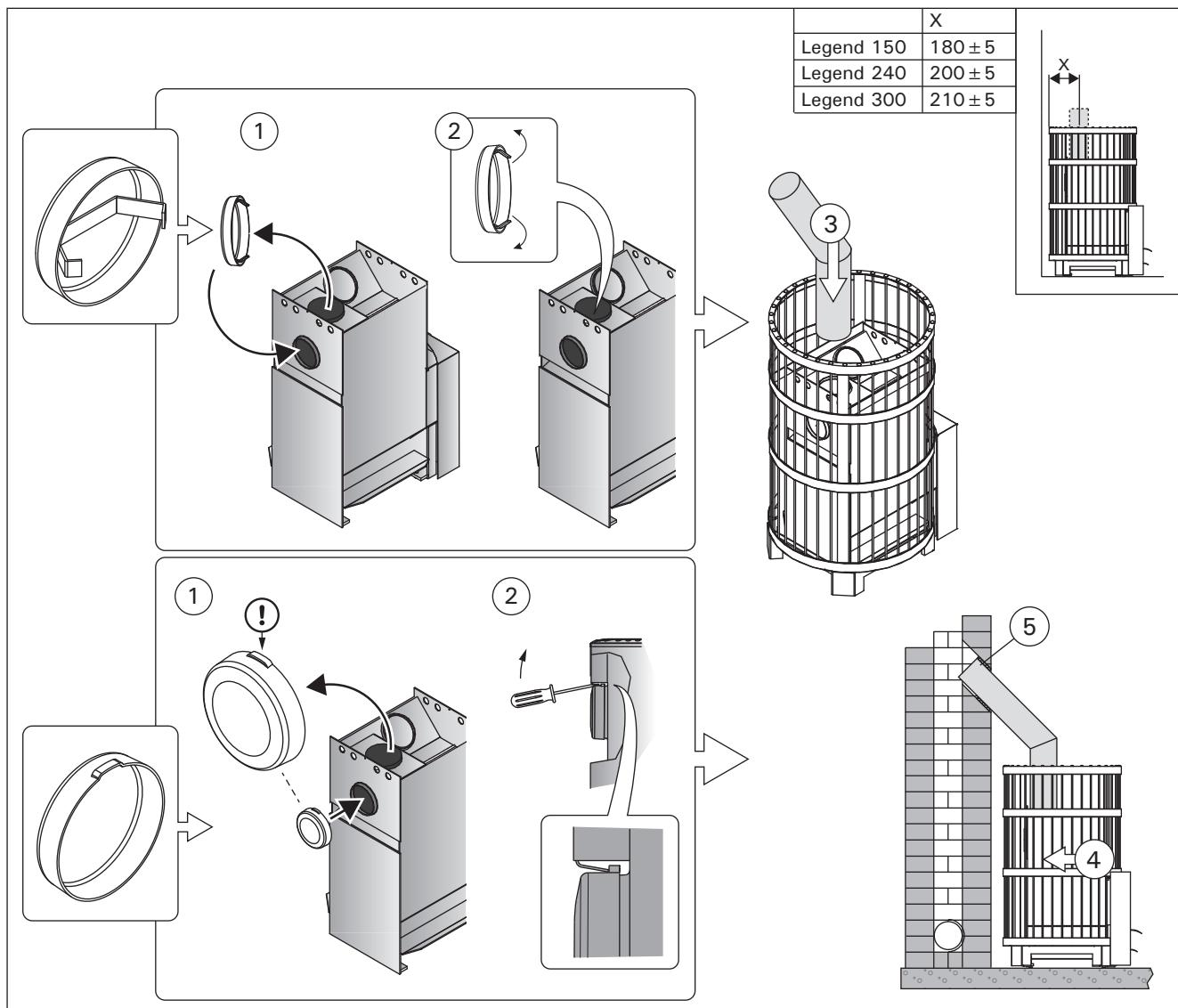
**Kuva 12. Kiukaan liittäminen muurattuun savuhormiin yläliitäntääukon kautta (mitat millimetreinä)**
