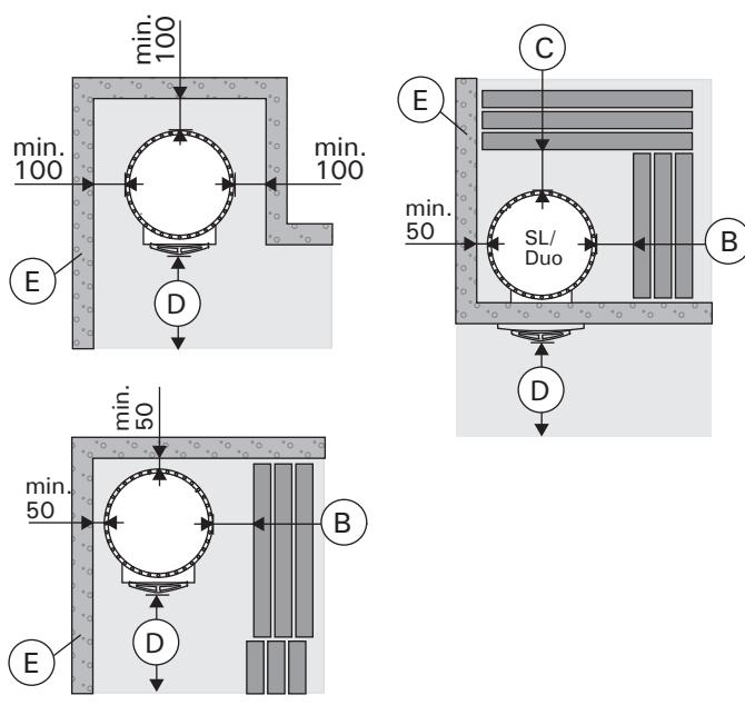
**Kuva 9.      Suojaetäisyydet (mitat millimetreinä)**
