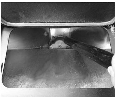
Joon 22 - Pelletisalve ja teo puhastamine
