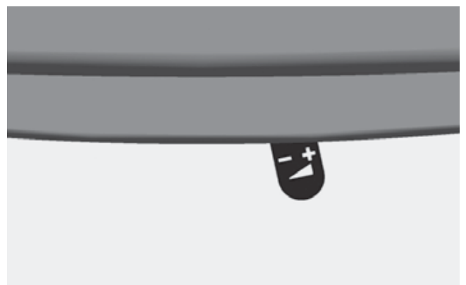
Abb. 4.8 Verbrennungslufschieber ganz nach rechts geschoben - Verbrennungsluft komplett geöffnet
