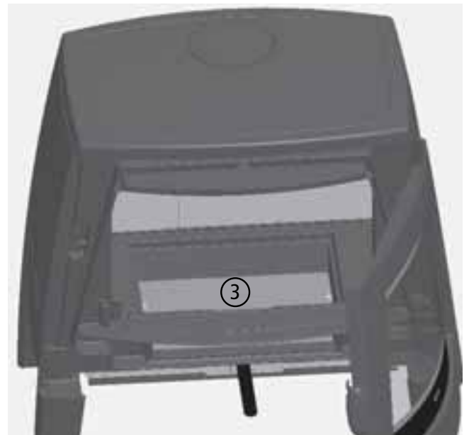
Abb. 4.20 Bodenblech / Ascheraum reinigen
