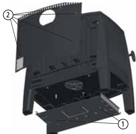
Abb. 3.2 Boden- und Rückwandblech abbauen
