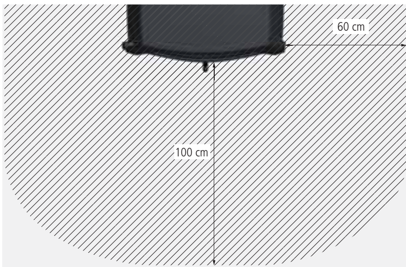
Abb. 1.3 Mindestabstände im Bereich der Sichtfenstertür
