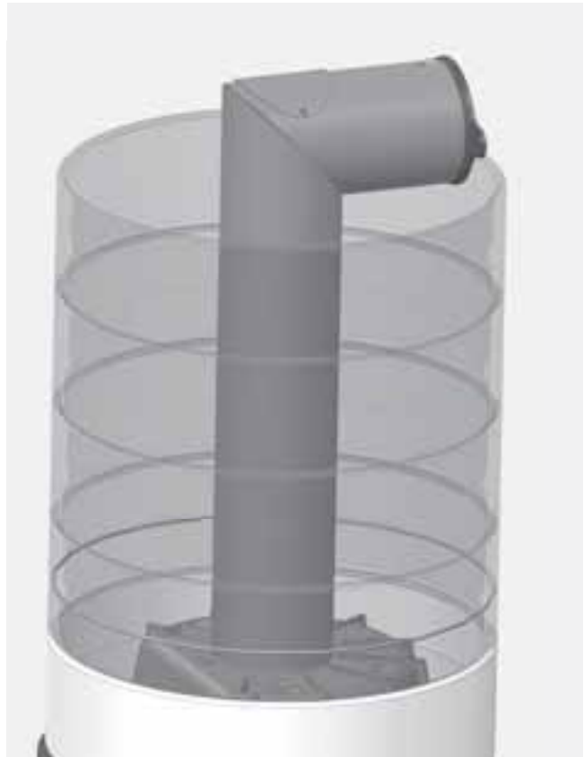
Abb. 3.42 im Aufsatz eingesetztes Heizgasrohr mit Anschlussflansch
