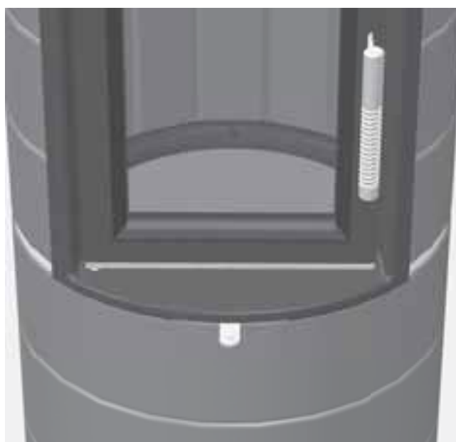
Abb. 4.5 Verbrennungsluft-Schieber, in der Mitte, Betrieb bei Nennwärmeleistung
