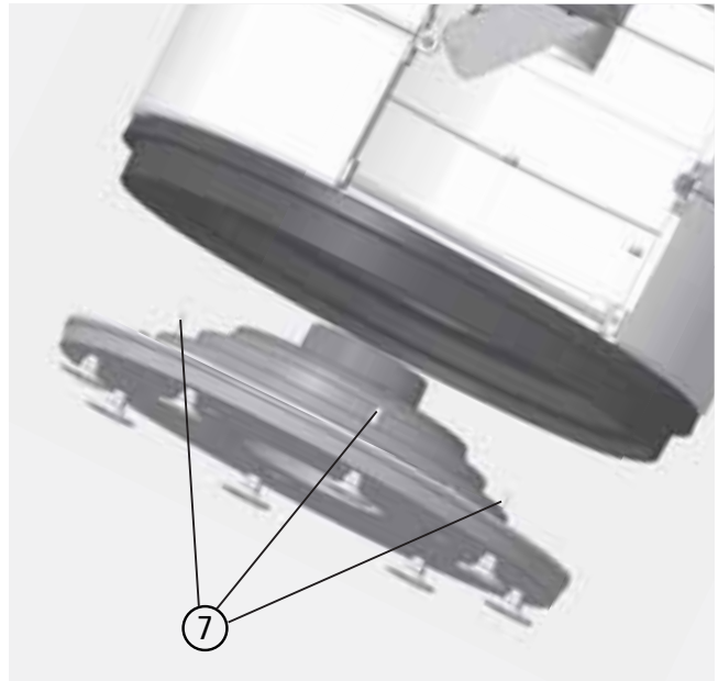
Abb. 3.11 Drehkonsole unter dem COLONA lite befestigen
