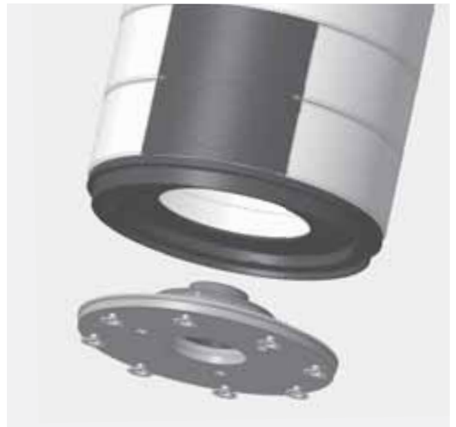
Abb. 3.4 Drehkonsole mit Grundplatte und Oberteil
