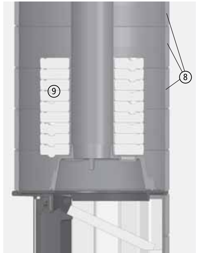
Abb. 3.39 Aufsatz mit 6 Gussringen und 9 Guss-Speichereinlagen
