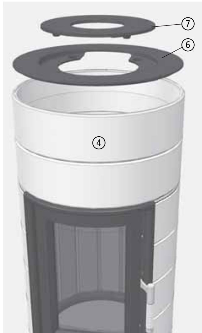
Abb. 3.38 Aufbau des Aufsatzes
