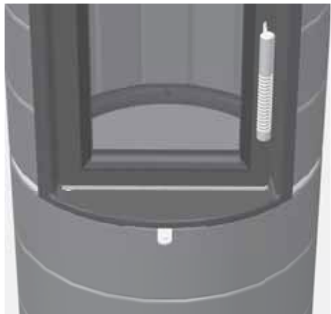
Abb. 4.8 Verbrennungsluft-Schieber, in der Mitte, Betrieb bei Nennwärmeleistung
