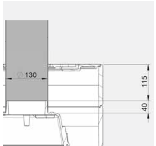
Abb. 3.46 Abstand Abgasstutzen zur Abdeckung bei COLONA lite mit 2 Gussringen
