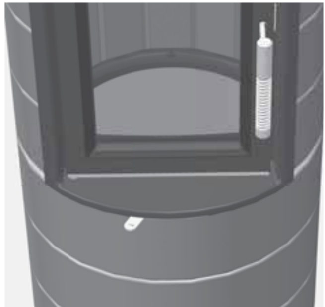
Abb. 4.6 Verbrennungsluft-Schieber, links, ganz geschlossen
