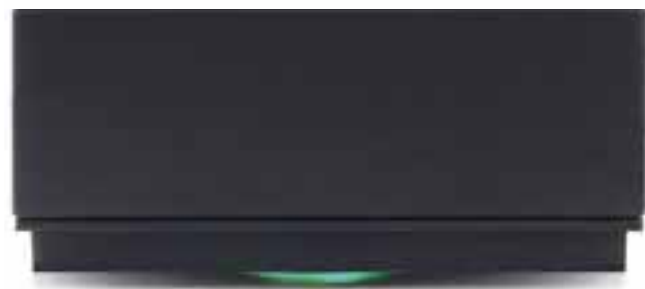
Abb. 4.26 LED-Lichtsignal bei Betrieb „ROT“ dann wieder „GRÜN“
