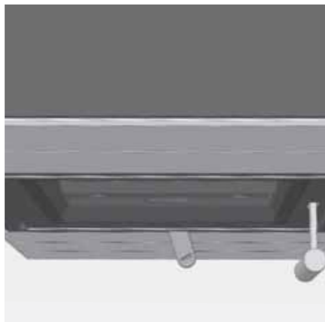
Abb. 4.11 Verbrennungslufthebel ganz rechts, Verbrennungsluft komplett geöffnet, Anheizen
