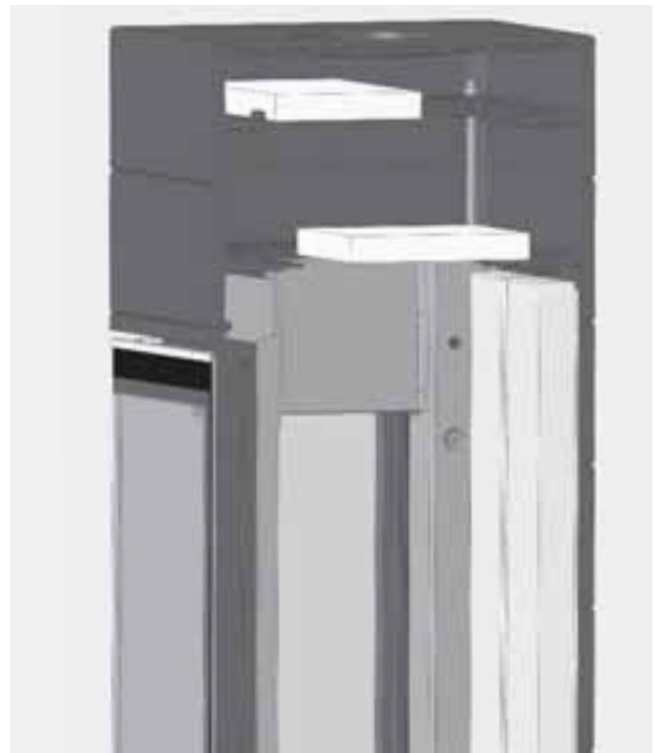
Abb. 4.31 Entnehmen der Umlenkungen (CORNA ES, Heizgasführung)
