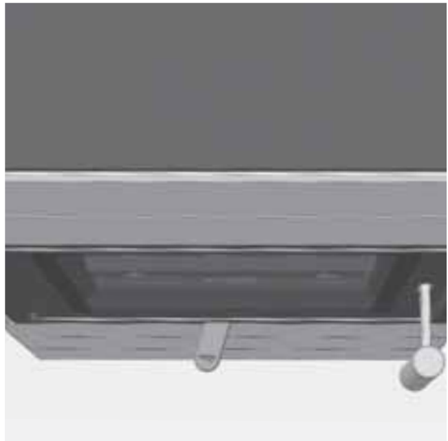
Abb. 4.3 Verbrennungslufthebel ganz links, Verbrennungsluft geschlossen
