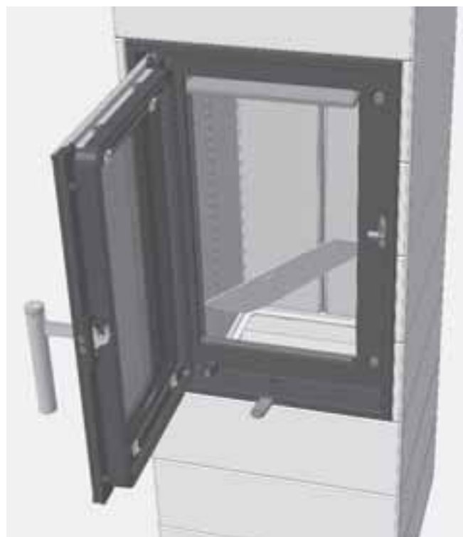
Abb. 4.29 Entnehmen des Bodenblechs im Brennraum
