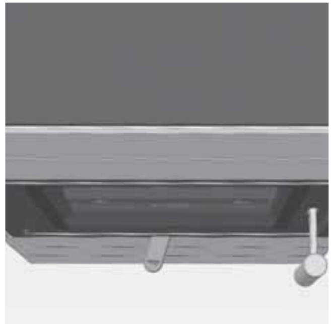
Abb. 4.7 Verbrennungslufthebel ganz links, Verbrennungsluft geschlossen
