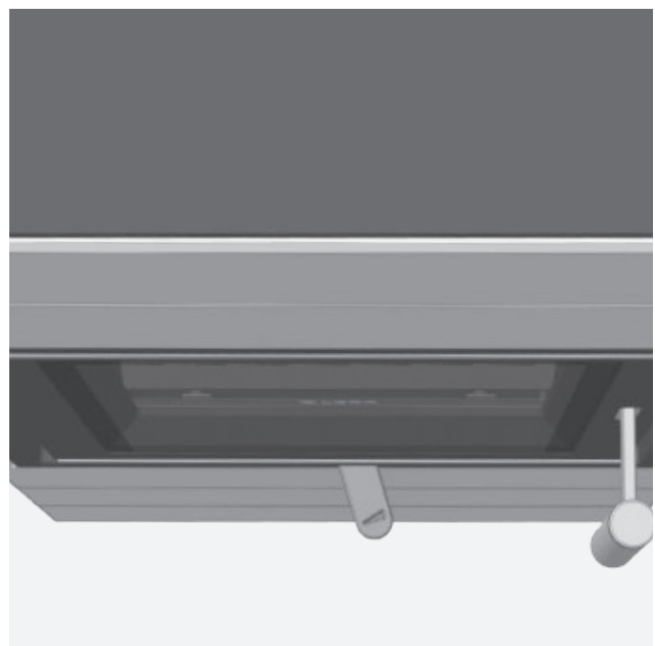
Abb. 4.8 Verbrennungslufthebel ganz rechts, Verbrennungsluft komplett geöffnet, Anheizen
