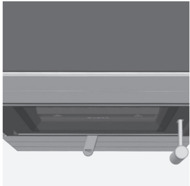
Abb. 4.7 Verbrennungslufthebel ganz links, Verbrennungsluft geschlossen
