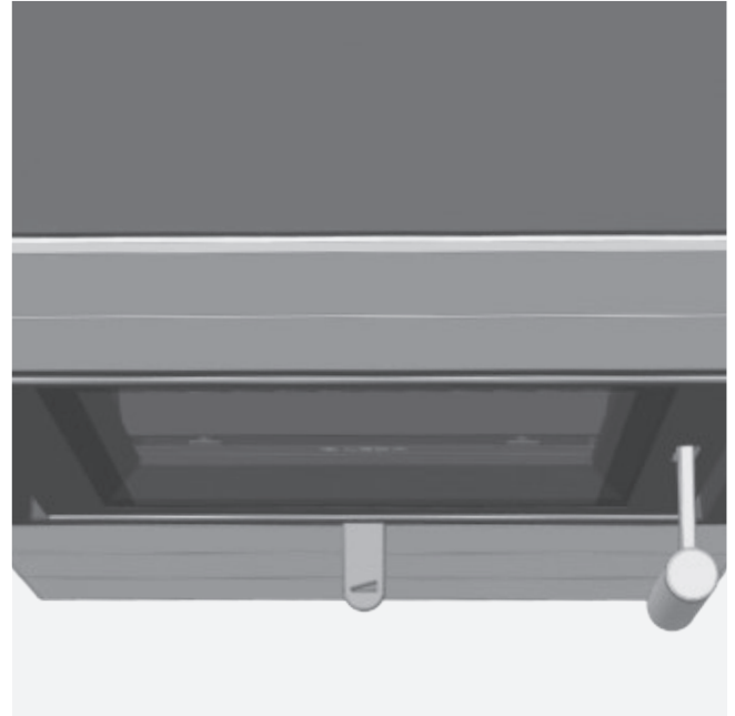
Abb. 4.5 Verbrennungslufthebel mittig, Verbrennungsluft auf Nennwärmeleistung
