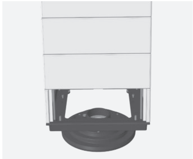
Abb. 3.10 Aufsetzen des Kaminofens auf der Drehkonsole
